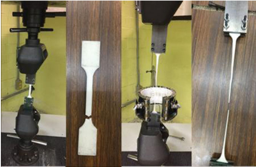
Fig. 13 ABS tensile test
