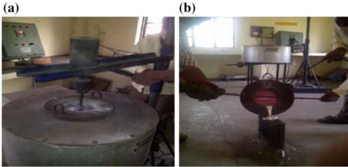
Fig. 2 a Stirring b Pouring the molten metal
