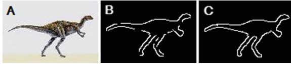
Fig. 2. The edge linking process. A - input image, B - edge detection, C - edge linking.
