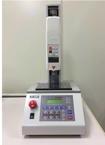
Fig. 1. Creep meter (JSV-H1000) [1].
