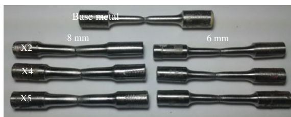
Fig. 7 Tensile test fracture
