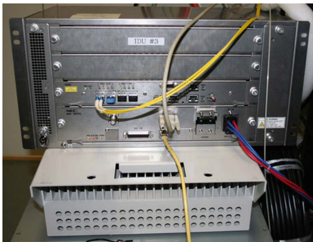
Fig. 3 NEC PasoWing basestation
