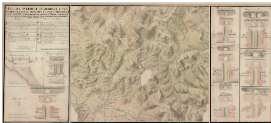
Fig. 2 Francisco Nande, Mapa del Puerto de Guadarrama y sus contornos en que se demuestra la nueva carretera , 1749. Manuscript map of the new road crossing the pass of Guadarrama, making a distinction between the works already carried out and those just planned. Approximate scale 1:24,000. (Courtesy of Archivo Cartográfico y de Estudios Geográficos del Centro Geográfico del Ejército, Ministerio de Defensa, Madrid. Bookmark: Madrid 126)
