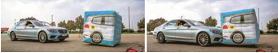
Fig. 1. Collision avoidance system not detecting an inflatable car dummy (Source: ÖAMTC (Österreichischer Automobil-, Motorrad- und Touring-Club))
