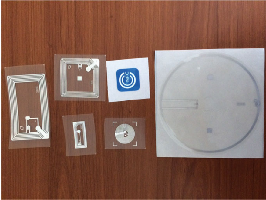
Fig. 21.1 Passive HF RFID tags
