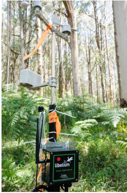
a. RISERnet geosensor mote
