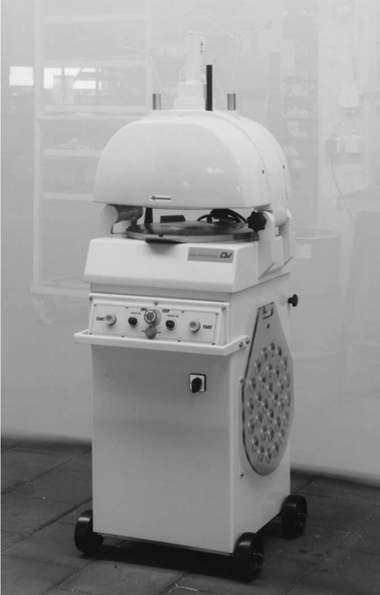
Fig. 4.24 An automatic bun divider–moulder (courtesy Daub Verhoeven)
