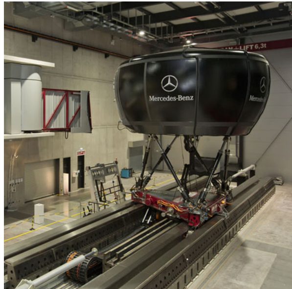
Fig. 4 Daimler’s dynamic simulator in Sindelfingen: motion system
