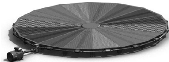
Abb. 2 CAD Modell des omnidirektionalen Bodens
