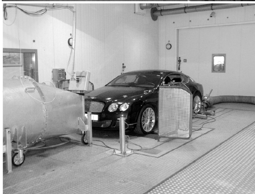
Fig. 3.7 Single roller chassis dynamometer: a) Instytut Transportu Samochodowego (Motor Transport Institute) in Warsaw, b) BOSMAL Sp. z o.o. Instytut Badań i Rozwoju Motoryzacji (Automotive Research and Development Institute)
