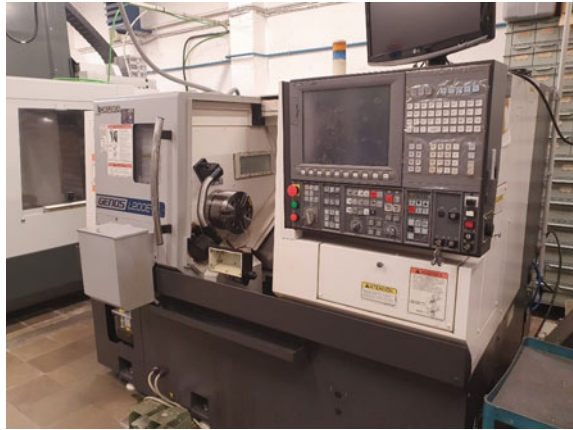
Fig. 2 Okuma genos L200E turning center
