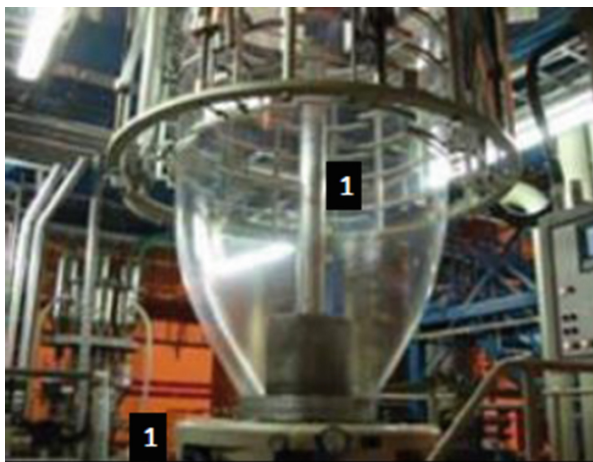
Fig. 2. HDEP film blowout.
