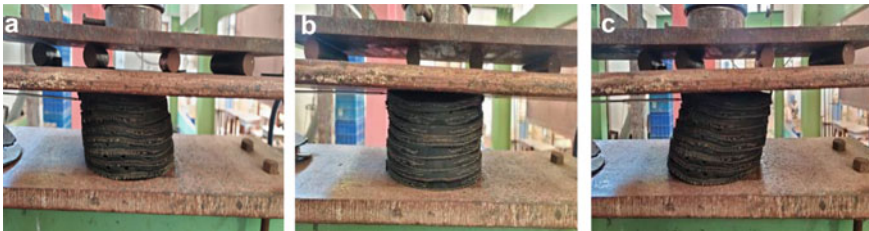
Fig. 5 a 8 Layer 2 MPa Specimen (+ 18 mm displacement), b 8 Layer 2 MPa Specimen, c 8 Layer 2 MPa Specimen (- 18 mm displacement)
