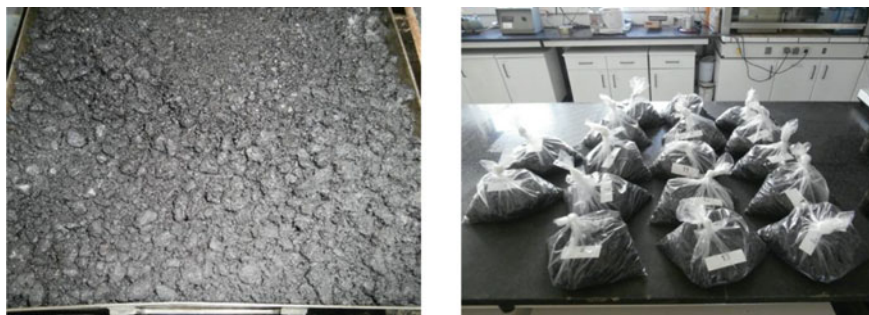
Fig. 2 Bituminous mixtures production
