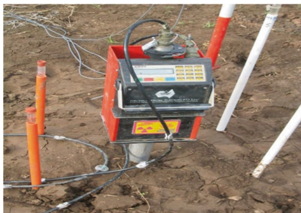
Fig. 6 Neutron moisture meter
