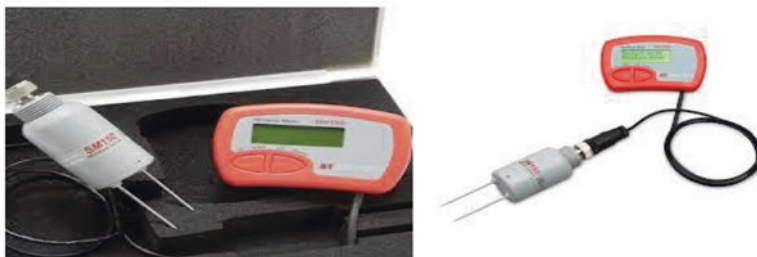
Fig. 4 Soil moisture meter SM-150
