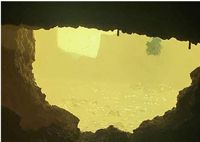
Fig. 8 Slag observation from the tapping door
