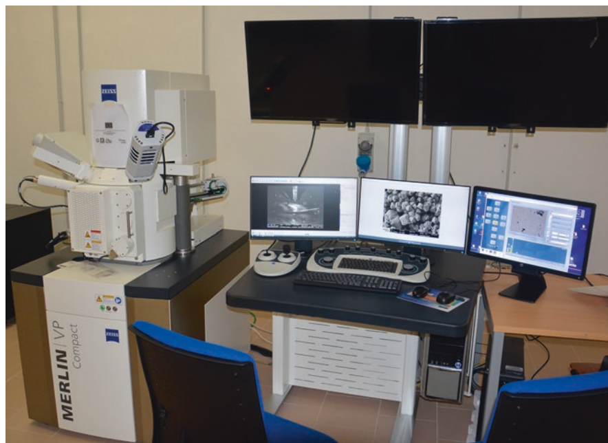
Fig. 3.1 Field Emission Scanning Electron Microscope (SEM) at DiSTAR – Dipartimento di Scienze della Terra, dell’Ambiente e delle Risorse – University of Napoli Federico II
