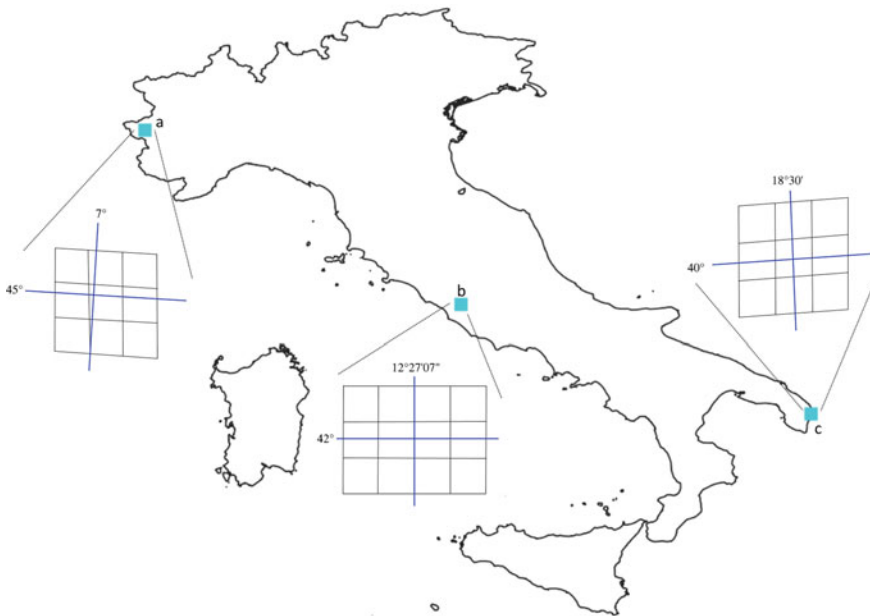
Fig. 2.3 Pieces of an ellipsoidal grid in three different zones of Italy: a North-Western zone, b along the meridian of origin, c South-Eastern zone. The different shape of the meshes can be observed, each having the same area / Porzioni di grigliato ellissoidico in tre zone diverse del territorio nazionale: a zona nord-occidentale, b centrale lungo il meridiano d'origine, c sud-orientale. Si osserva la diversa forma delle maglie, tutte aventi medesima superficie
