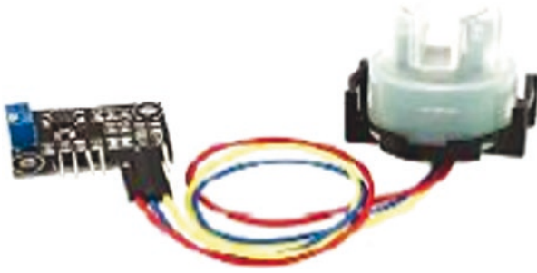
Fig. 6 Arduino turbidity sensor (Mithya et al., 2019)
