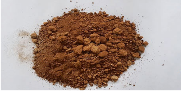
Fig. 52.1 Effluent Treatment Plant (ETP) sludge
