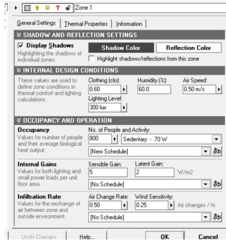
Fig. 3. Thermal parameter setting in Ecotect software
