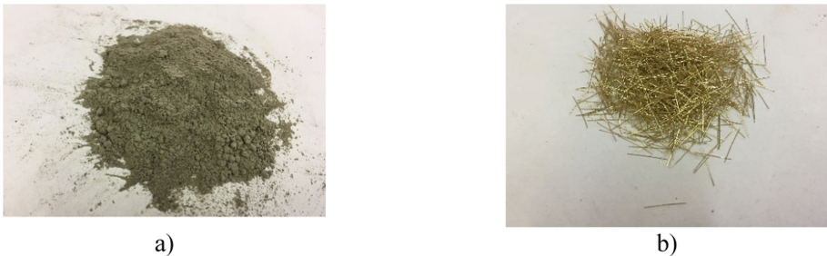
Fig. 2. FRCC, a) matrix, b) steel fibres.
