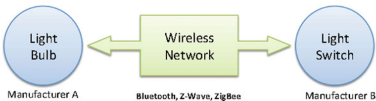
Fig. 8.4 Device to device model (Kulkarni & Kulkarni, 2017)
