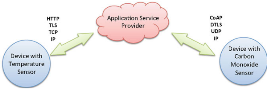
Fig. 8.5 Device to cloud model (Kulkarni & Kulkarni, 2017)
