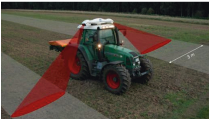
Fig. 41 Nitrogen fertilizer application using a 45-degree Yara N-Sensor ALS [84]
