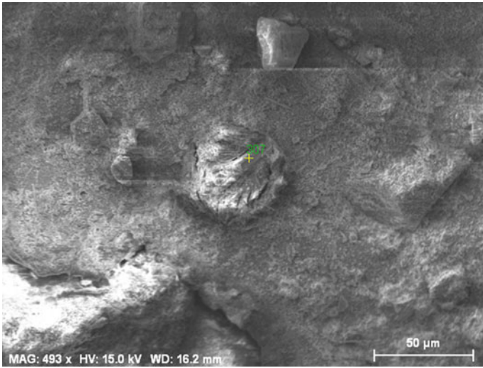
Fig. 13 Ettringite crystals filling a pore
