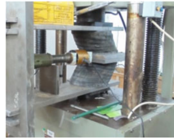
(d) Compression-shear test of the rubber isolator.
