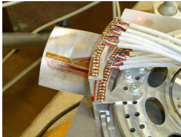
Fig. 11.12 Instrumented turbine blade (courtesy of Vrije Universiteit Brussel, S. Vanlanduit)
