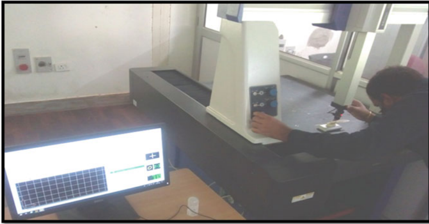
Fig. 5.9 CMM ( Mitutoyo Crysta M574 plus)
