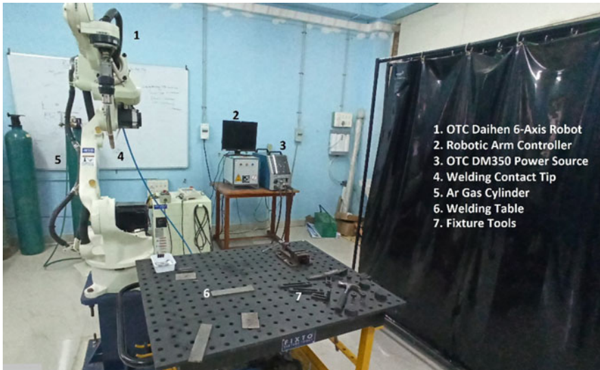
Fig. 24.1 WAAM setup
