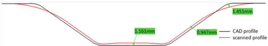
Fig. 27 Dimensional precision for CONE-D85H20 \alpha 35 \Delta z1 part [5]
