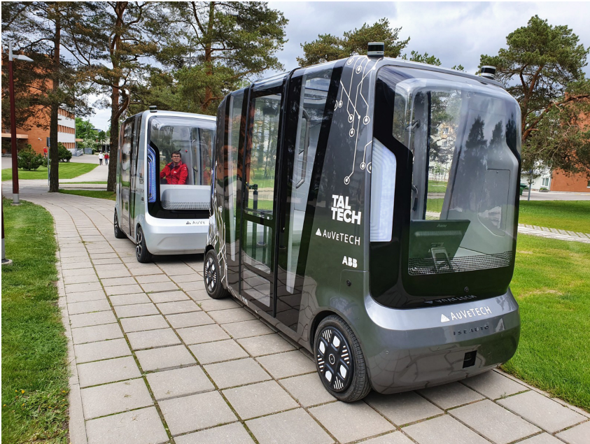
Fig. 2. Version 1 and Version 1.1 of AV shuttle ISEAUTO
