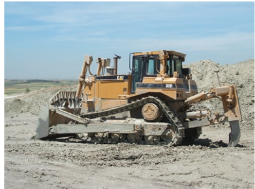
■ Fig. 2.22 Ripping dozer
