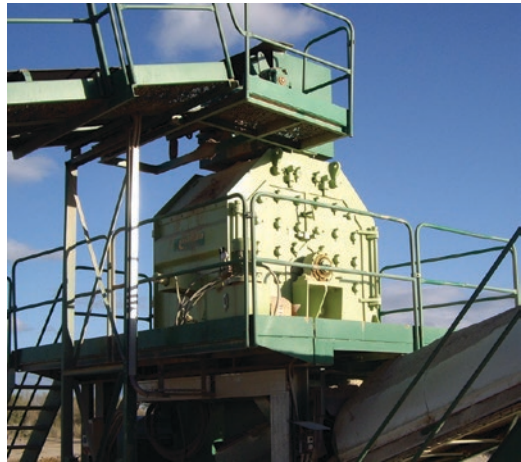
■ Fig. 2.40 Impact mill. (Image courtesy of Luis Fueyo)
