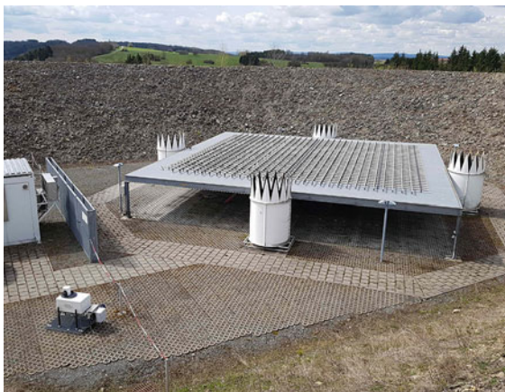
Fig. 31.10 482 MHz radar wind profiler of the Deutscher Wetterdienst. A 1.5 \mu\text{m} Doppler lidar is visible in the foreground (photo © R. Leinweber) ◀
