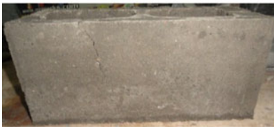
Crack on one surface after crushing (d) GHB7
