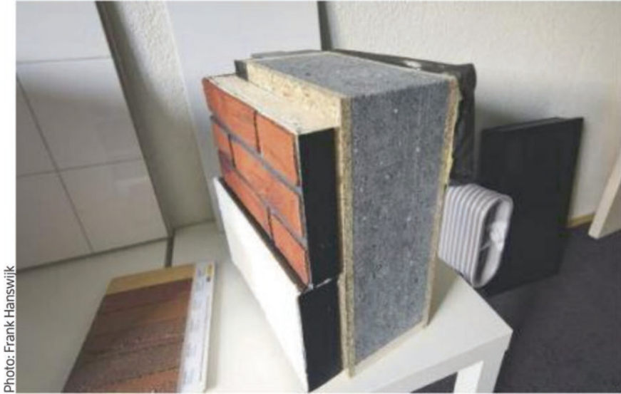
Fig. 22.4 Prototype of the wall block used to wrap the Arnheim row house (NL) in 2014. Source: “Energiesprong Italia: un “salto energetico” per il retrofitting del futuro” edited by aZero in collaboration with Thomas Maiorin, aZero n. 24, pp. 48–57—EdicomEdizioni
