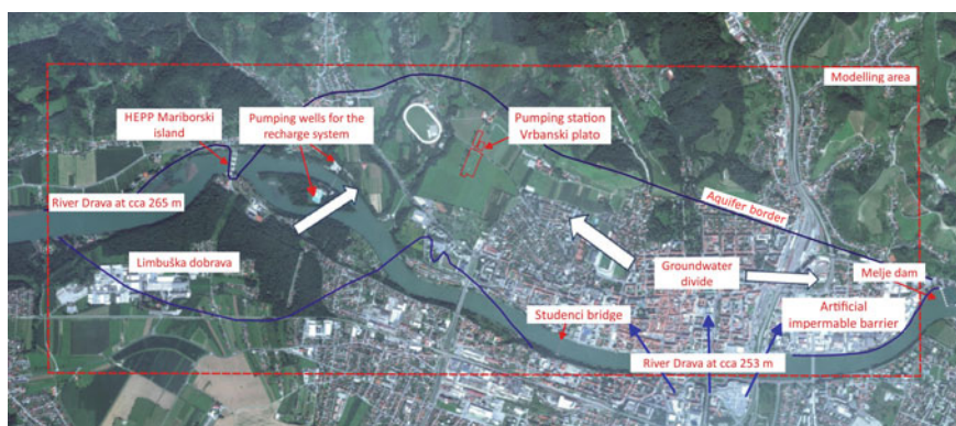
Fig. 4.2 Conceptual model of Vrbanški Plato aquifer (Kopač and Vremec 2017a, b)
