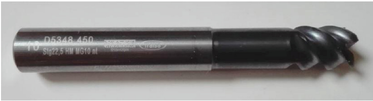
Fig. 4. Cylindrical end mill: FRAISA D5348 450.
