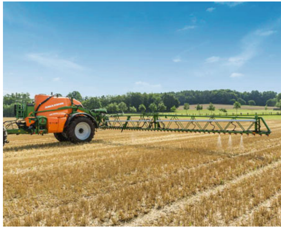
Fig. 28.5 Spot spraying technology installed on a field sprayer from Amazonen-Werke, http://go.amazone.de/agritechnical/2017/neuheiten/pflanzenschutztechnik/anhaengespritze-ux-amaspot/
