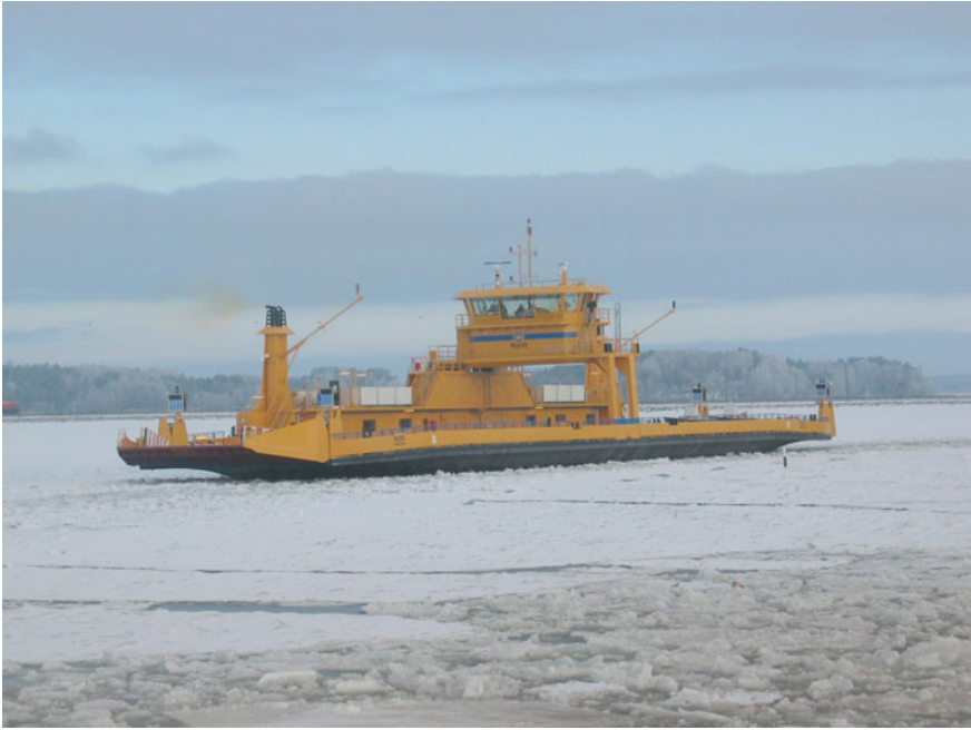
Fig. 4.2 Ice-going road ferry “Pluto”, a type of double-ended ferry (Uudenkaupungin Työvene Oy)
