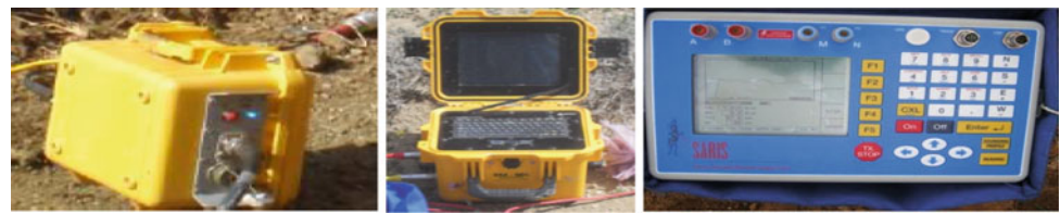
(a) Geode Geometricsn (b) Summit X Stream Pro (DMT) (c) résistivimètre Saris.
