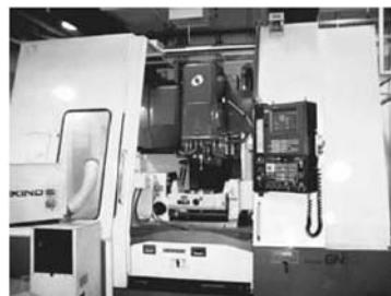
(a) Actual 6-axis control machine tool (Makino GN-107A)
