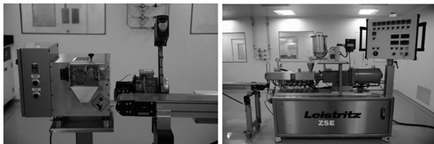
Fig. 10.13 Extruder and pelletizer setup for nifedipine mini tablet extrusion
