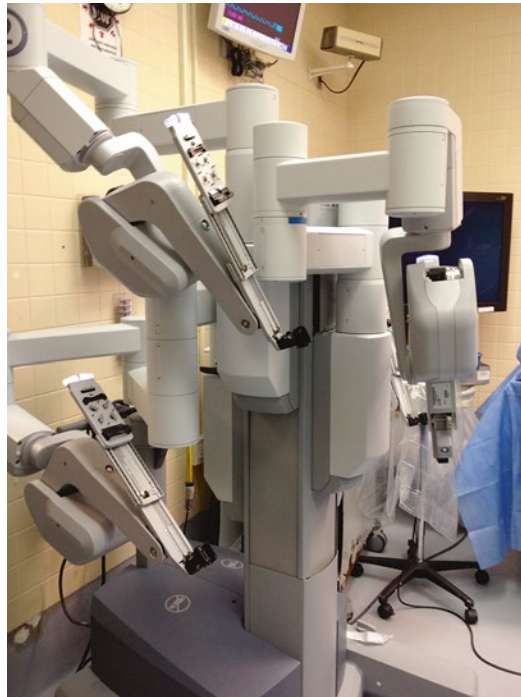
Fig. 2.21 Da Vinci® robot (Intuitive Surgical, Inc., Sunnyvale, CA)
