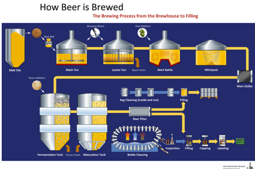
Fig. 23.3 A schematic representation of the brewing process (Gesellschaft für Öffentlichkeitsarbeit der Deutschen Brauwirtschaft e. V.)
