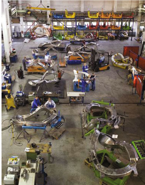
Fig. 4.44 Final production of the magnet coils at Babcock Noell Magnettechnik GmbH in Zeitz. Courtesy of Lutz Wegener, Max-Planck Institut für Plasmaforschung, Greifswald, Germany. (Photo IPP, André Künzelmann)
