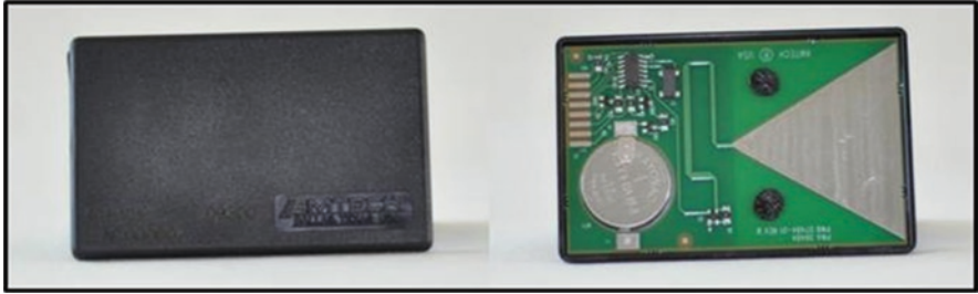
Fig. 1.10 Example of semi-passive tags
